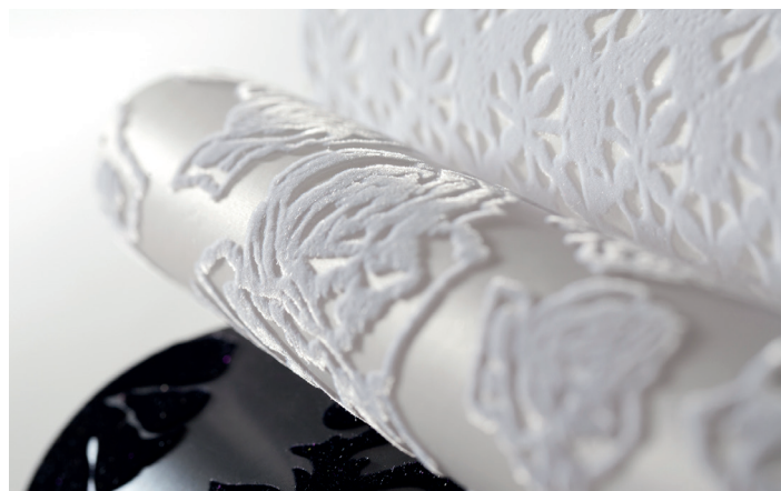
Rotations-Druckanlage, auf der Tapeten beflockt werden (Fotos: Kissel + Wolf)
