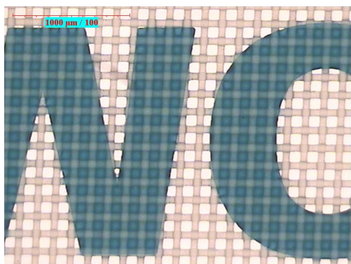
Makro auf Siebgewebe SEFAR PET 1000 68-55W, Linienbreite ca. 300µm
